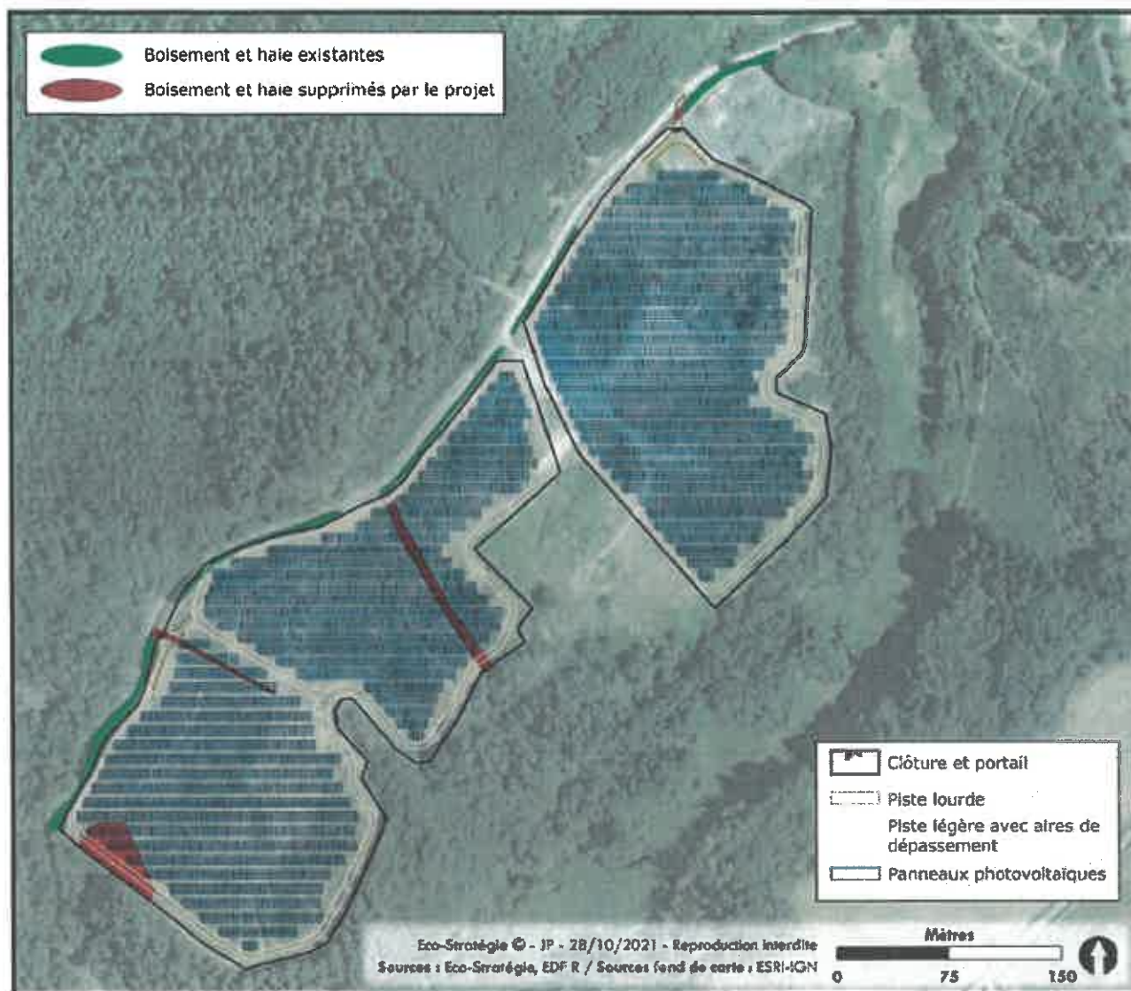
Figure 105. Incidence du projet sur les éléments boisés (haies, fourrés)
